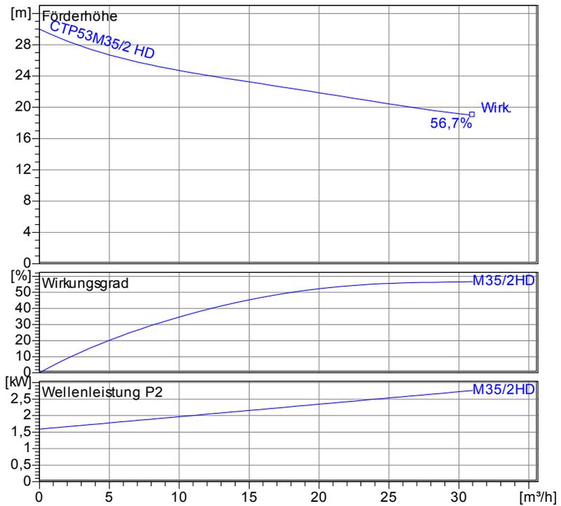
Tauchbetrieb mit Bodenaufstellung 2,0-2,8kW
