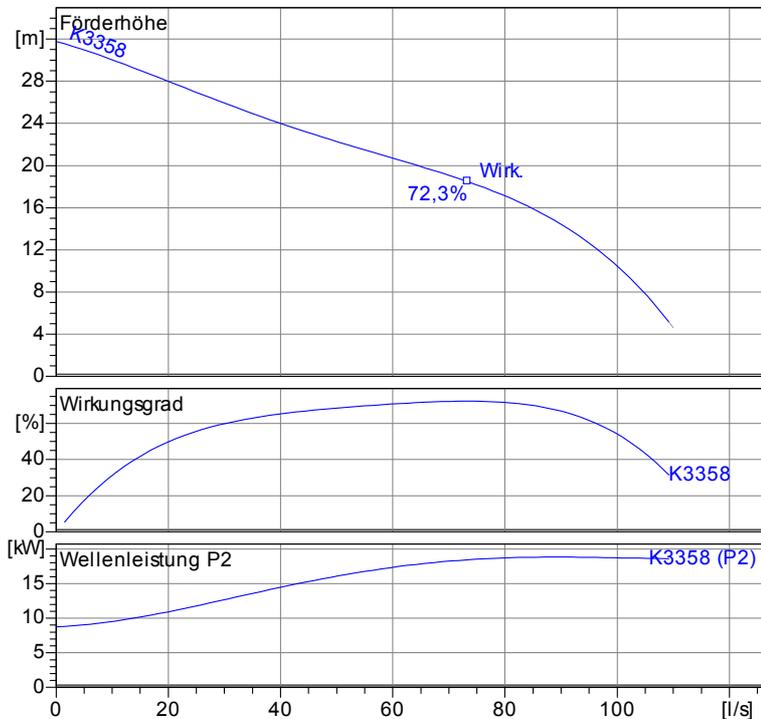
Tauchbetrieb mit Kupplungssystem DN150 (PU-52-58)
