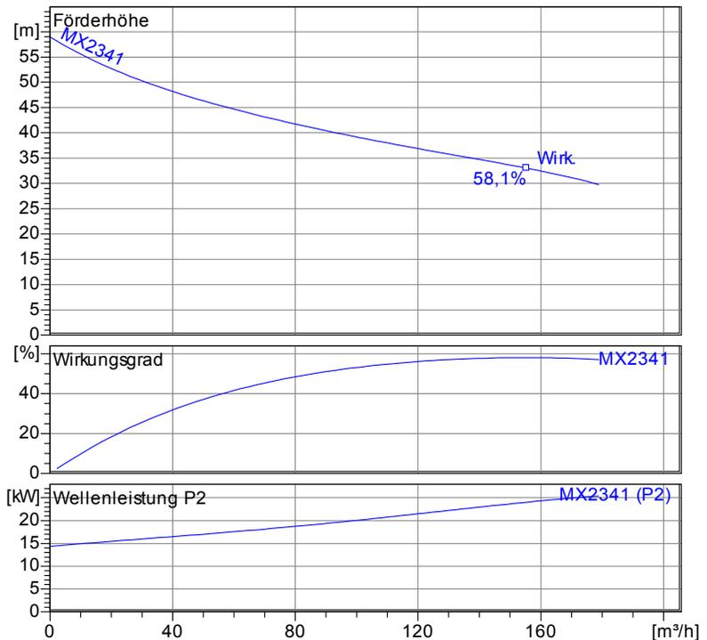
Tauchbetrieb mit Kupplungssystem (P-Motor)
