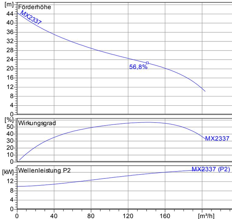
Tauchbetrieb mit Kupplungssystem (PU-Motor)
