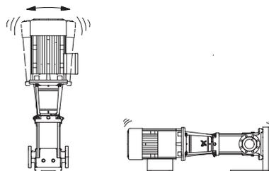
Abb. 8 Schwingungen von Pumpen in erdbebengefährdeten Gebieten
