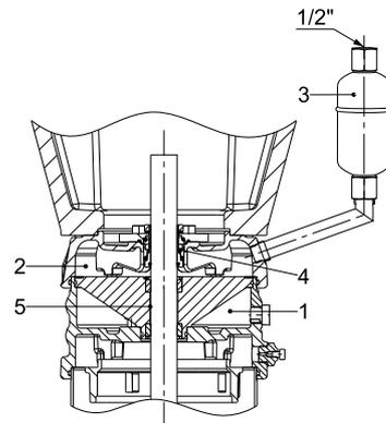
Abb. 45 CR 120 und 150 mit luftgekühlter Wellendichtungskammer
