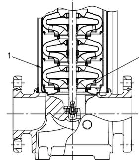
Abb. 54 Schnittzeichnung einer CR-Pumpe mit niedrigem NPSH-Wert
