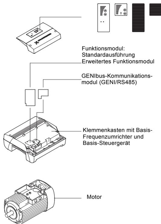
Abb. 75 Kombination der Motorkomponenten von kundenspezifisch hergestellten CRE-Pumpen
